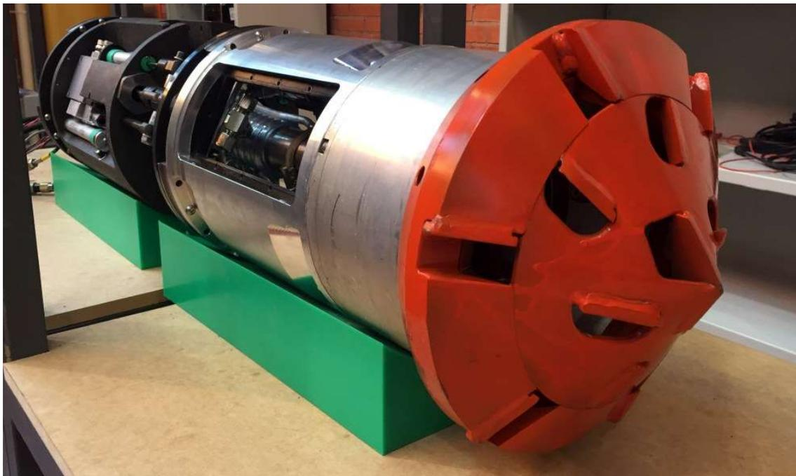
Badger, 是一台由一个钻头，两个固定模块以及两个推进和操纵模块组成的三米长的钻孔机器人。
